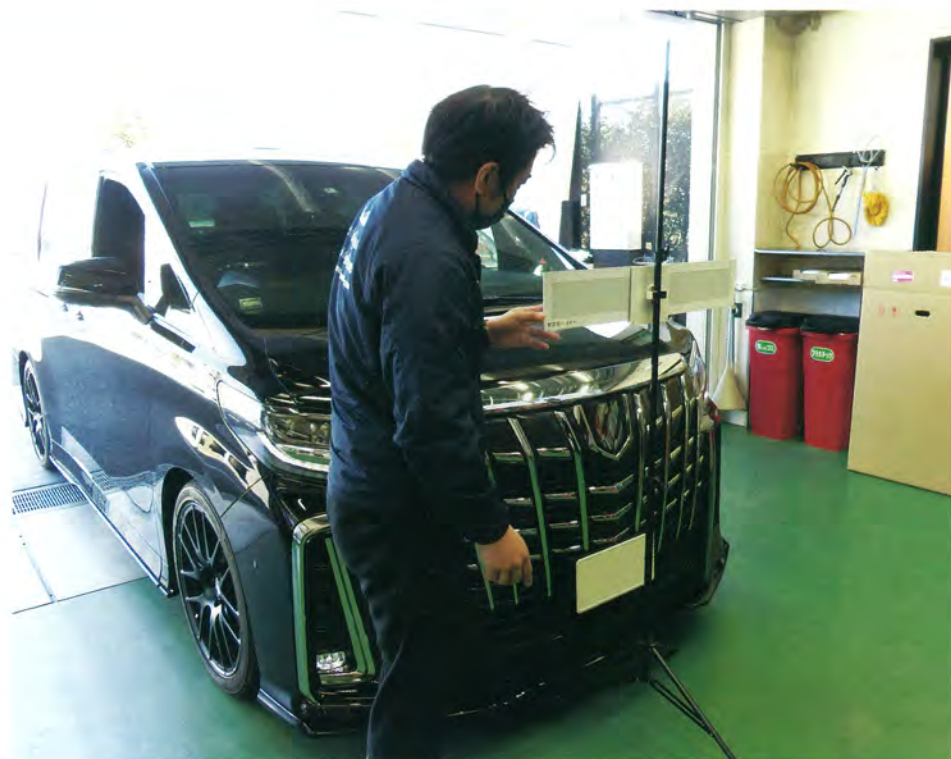
フロントガラス交換に伴い日常的にエーミング作業を実施
